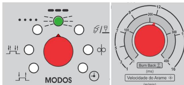
Ligando a Fonte de soldagem com a tecla “SET” (CH2 – face traseira da placa) pressionada e o Potenciômetro de Modos [4] apontado para a função **Intermitente**, o LED associado irá piscar. Através do *Potenciômetro velocidade do arame* e *Burn Back* [5], o operador definirá o modelo da máquina:
