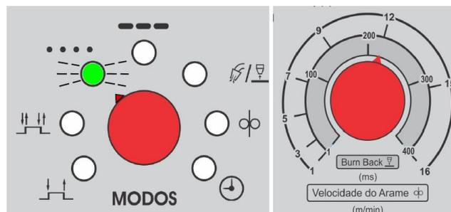
Ligando a fonte de soldagem com a tecla “SET” (CH2 – face traseira da placa) pressionada e o Potenciômetro de Modos [4] apontado para a função **Ponteamento**, o LED associado irá piscar. Através do *Potenciômetro velocidade do arame e Burn Back* [5], o operador definirá o tipo de alimentador:
