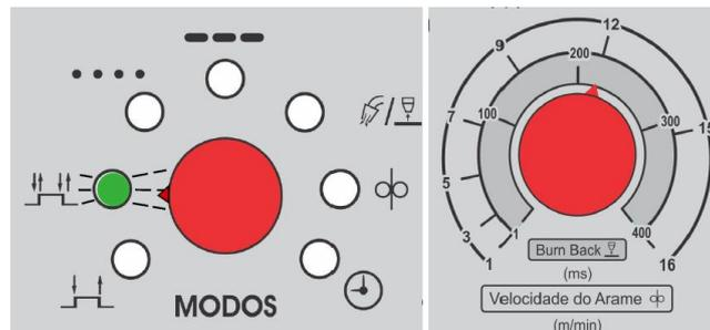
Ligando a Fonte de soldagem com a tecla “SET” (CH2 – face traseira da placa) pressionada e o Potenciômetro de Modos [4] apontado para a função **4 Passos**, o LED associado irá piscar. Pressionando o gatilho e mantendo pressionado o ajuste de velocidade máxima poderá ser feito através do *Potenciômetro velocidade do arame e Burn Back* [5], quando chegar à velocidade desejada soltar o gatilho e pressionar novamente. Todos os LED’s irão ascender por um segundo indicando a gravação.
