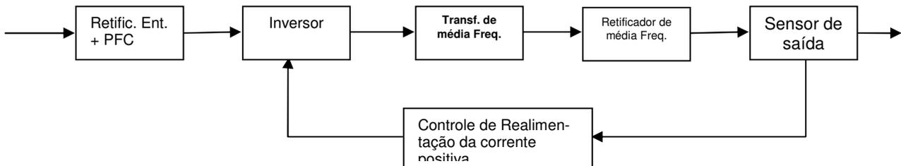
Figura 1- Diagrama de blocos da fonte MaxxiARC
