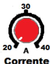
**Figura 4- Potenciômetro de regulagem da corrente de corte**
