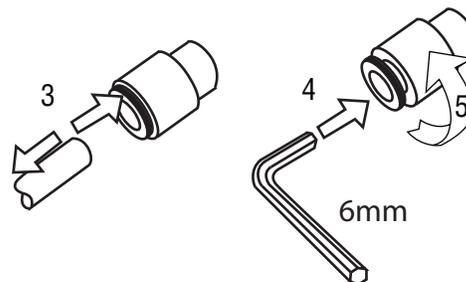
5. Remova a conexão do conjunto do elemento filtrante inserindo uma chave hallen de 6 mm na parte interna da conexão e gire no sentido anti-horário (esquerda). Numeros 4 e 5 na figura anterior.
