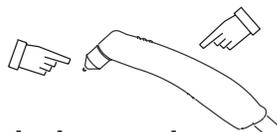
Faça inspeção visual nos cabos e mang. Troque se necessário
