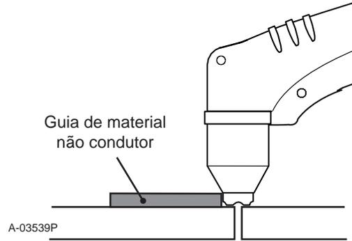
Usando o bocal de arraste com uma régua.
