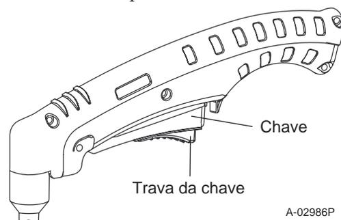
5. Mova a tocha para a distância de transferência para a obra. O arco principal deve transferir para a obra, e o arco piloto irá desligar-se.
