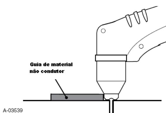
Utilizando o bocal de arraste com uma régua.
