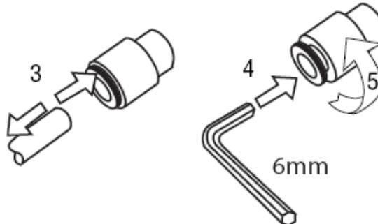
5. Remova a conexão do conjunto do elemento filtrante inserindo uma chave Hallen de 6 mm na parte interna da conexão e gire no sentido anti-horário (esquerdo). Números 4 e 5 na figura anterior.
