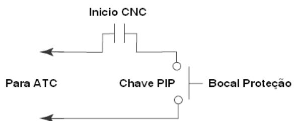
Diagrama do circuito de Peca no Local da tocha mecanizada
