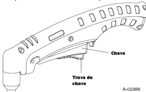
6. Mova a tocha para a distância de transferência para a obra. O arco principal deve transferir para a obra, e o arco piloto irá desligar-se.
