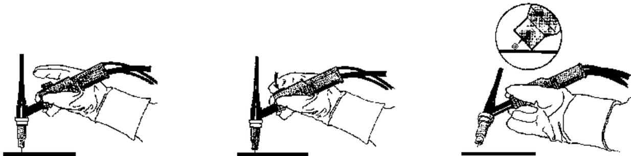
Formar o arco com a função LiftArc.
