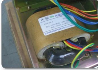
Figura21 - Transformador auxiliar
