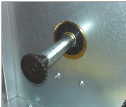
Figura 4 – Suporte para arame de 1kg
