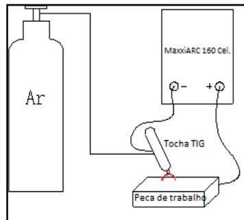
**Figura 4- Diagrama para soldagem TIG**
