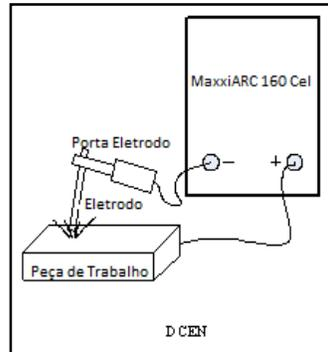
Figura 2- Conexão negativa para soldagem com eletrodo revestido
