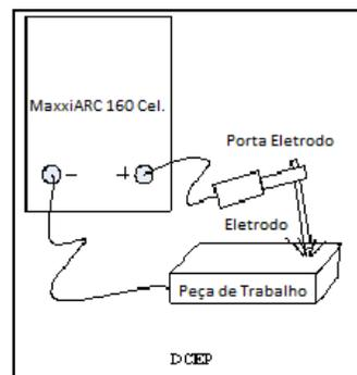
Figura 3- Conexão positiva para soldagem com eletrodo revestido
