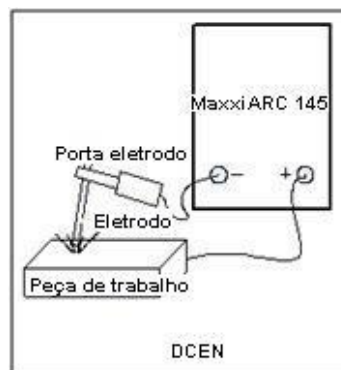
Figura 3 - Conexão negativa para soldagem com eletrodo revestido
