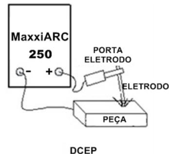
Figura 3 – Conexão positiva para soldagem com eletrodo revestido
