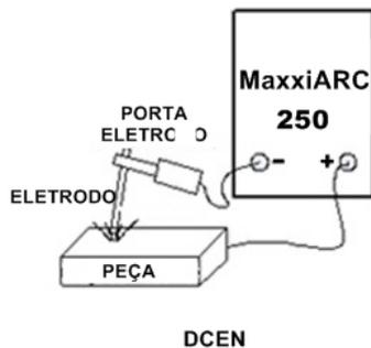
Figura 2 – Conexão negativa para soldagem com eletrodo revestido
