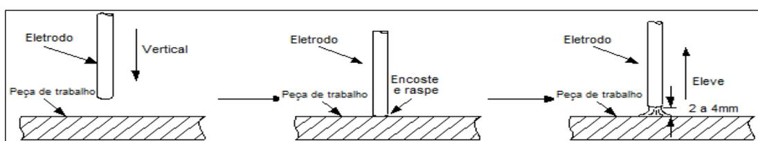
Figura 8 – Abertura de arco com eletrodo revestido
