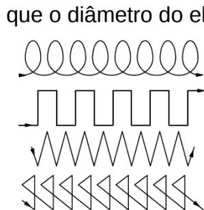
Deslocamento lateral do eletrodo em relação ao eixo do cordão (tecimento). Este movimento é utilizado para se depositar um cordão mais largo, fazer flutuar a escória, garantir a fusão das paredes laterais da junta e para tornar mais suave a variação de temperatura durante a soldagem. O tecimento deve ser, em geral, restrito a uma amplitude inferior a cerca de 3 vezes o diâmetro do eletrodo. O número de padrões de tecimento é muito grande. Veja ao lado.
