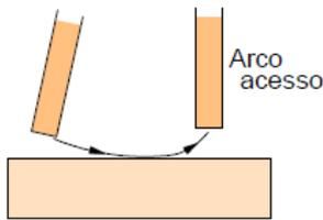
Movimento de mergulho do eletrodo em direção à poça de fusão de modo a manter o comprimento de arco constante. Para isto, a velocidade de mergulho deve ser igualada à velocidade de fusão do eletrodo, a qual depende da corrente de soldagem.
