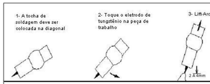
Figura 4: Método de abertura de arco com Lift Arc
