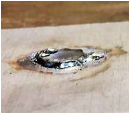
Ponto de solda na chapa inferior
