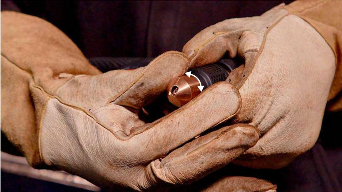
2. Confirme se o lado plano da ponta do cartucho está alinhado com o lado plano da peça de trabalho. Ajuste conforme necessário.
