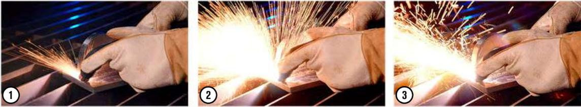
8. Arraste o lado plano da ponta do cartucho pelo lado plano da peça de trabalho. Mantenha um afastamento de 3 mm–6 mm da peça de trabalho vertical. Mantenha um ritmo estável.
