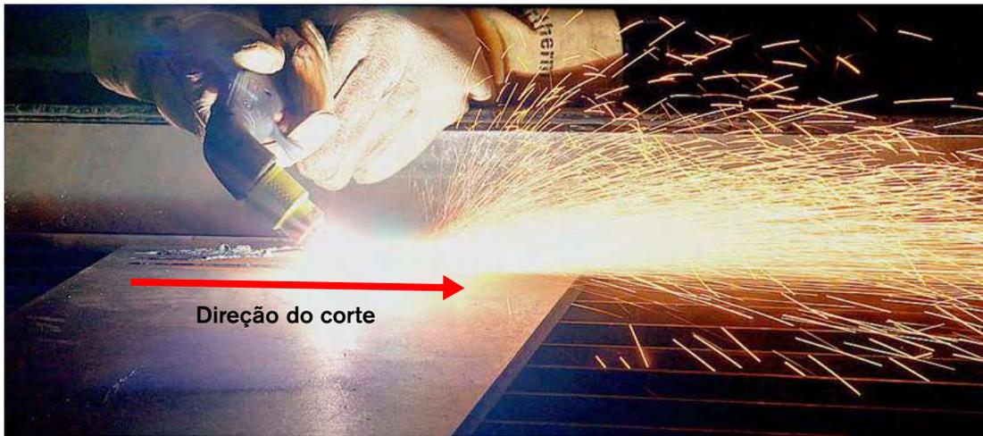
6. Conforme necessário, altere a posição da tocha para obter o contorno de goivagem que deseja. Consulte [Alteração do contorno da goivagem](#) na página 117. Mantenha pelo menos uma pequena distância entre a ponta da tocha e o metal fundido para aumentar a vida útil do cartucho e evitar danos à tocha.
