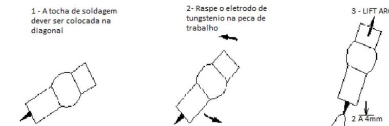
Figura 7: Método para abertura de arco com Lift Arc
