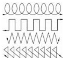
2. Translação do eletrodo ao longo do eixo do cordão com a velocidade de soldagem. Na ausência do terceiro movimento (tecimento), a largura do cordão deve ser cerca de 2 a 3 mm maior que o diâmetro do eletrodo quando uma velocidade de soldagem adequada é usada.
