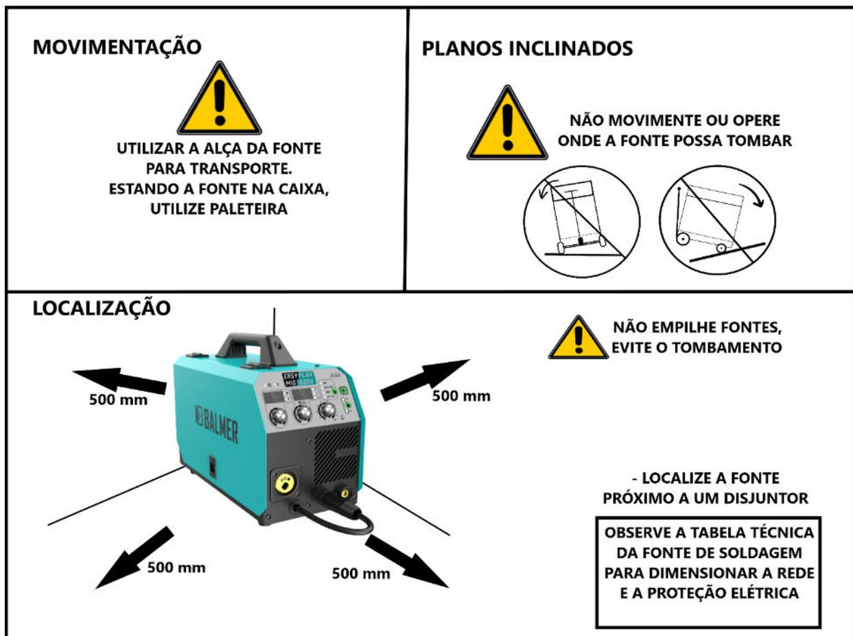
Figura 2 - Atribuições de local de instalação
