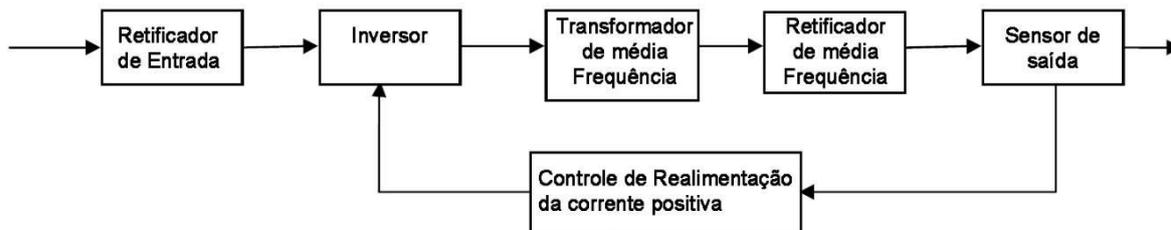
Figura 1 - Diagrama de blocos Easy Flex MIG 160DV
