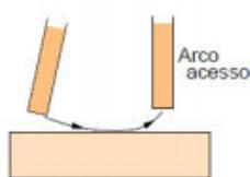
1. Movimento de mergulho do eletrodo em direção à poça de fusão de modo a manter o comprimento de arco constante. Para isto, a velocidade de mergulho deve ser igualada à velocidade de fusão do eletrodo, a qual depende da corrente de soldagem.
